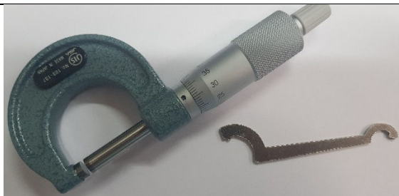
รูปตัวปรับสเกล และรูกระบอกสเกลสำหรับตัวปรับสเกล
