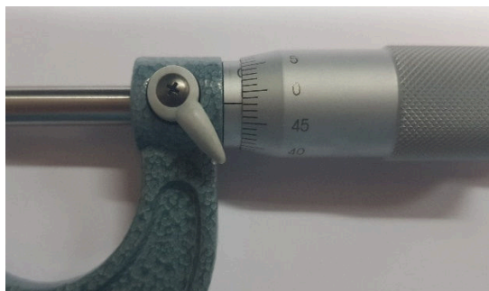
รูปไมโครมิเตอร์ที่สเกลคลาดเคลื่อน
