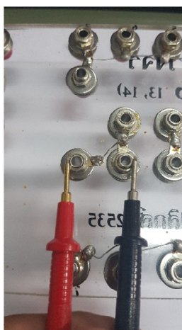
รูปการใช้นิ้วมัลติมิเตอร์วัดระหว่างจุดเชื่อมต่อ
